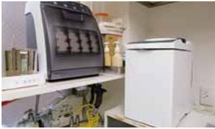
図20. THP専用自動注油装置と滅菌器
