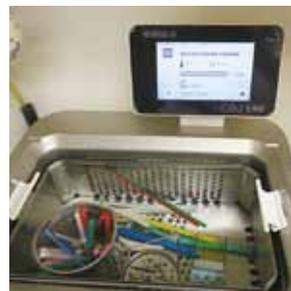
図17. 温度設定が可能な超音波洗浄器
