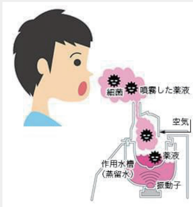
図1. エアロゾル(小さい水滴)を発生する。したがって、水が細菌汚染を受けると、細菌を含有したエアロゾルを噴出する。
