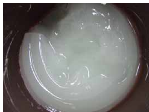
外気温が高い時期における使用中の状態 表面が柔らかくなり、液状の分離が見られます
