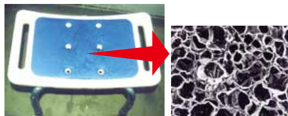
図3. スポンジ様材質（ポリウレタンフォーム）の電子顕微鏡写真 孔が密集した構造である（バースケール=100μm）
