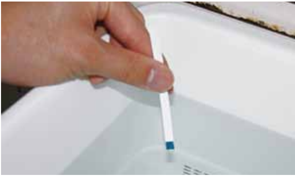
図4. 試験紙を用いた次亜塩素酸ナトリウム濃度の測定
